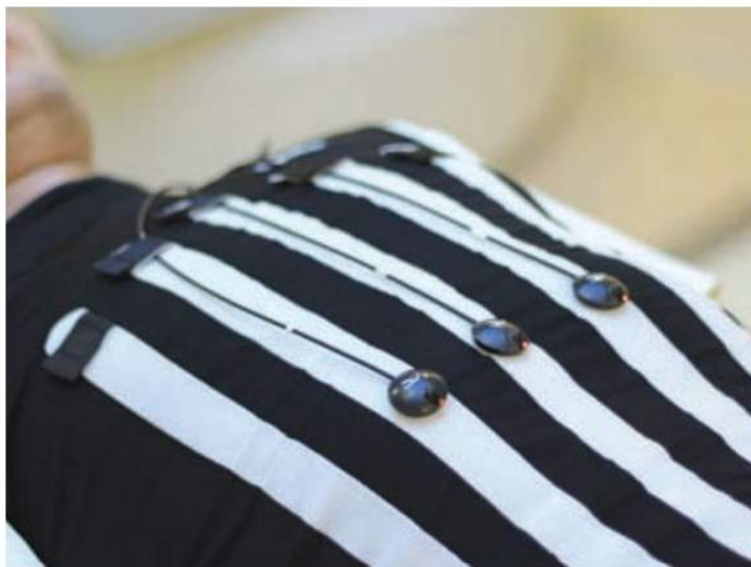
Kamizelka Synchrony wraz z diodami podczerwieni stosowana przy śledzeniu toru oddechowego chorego.
